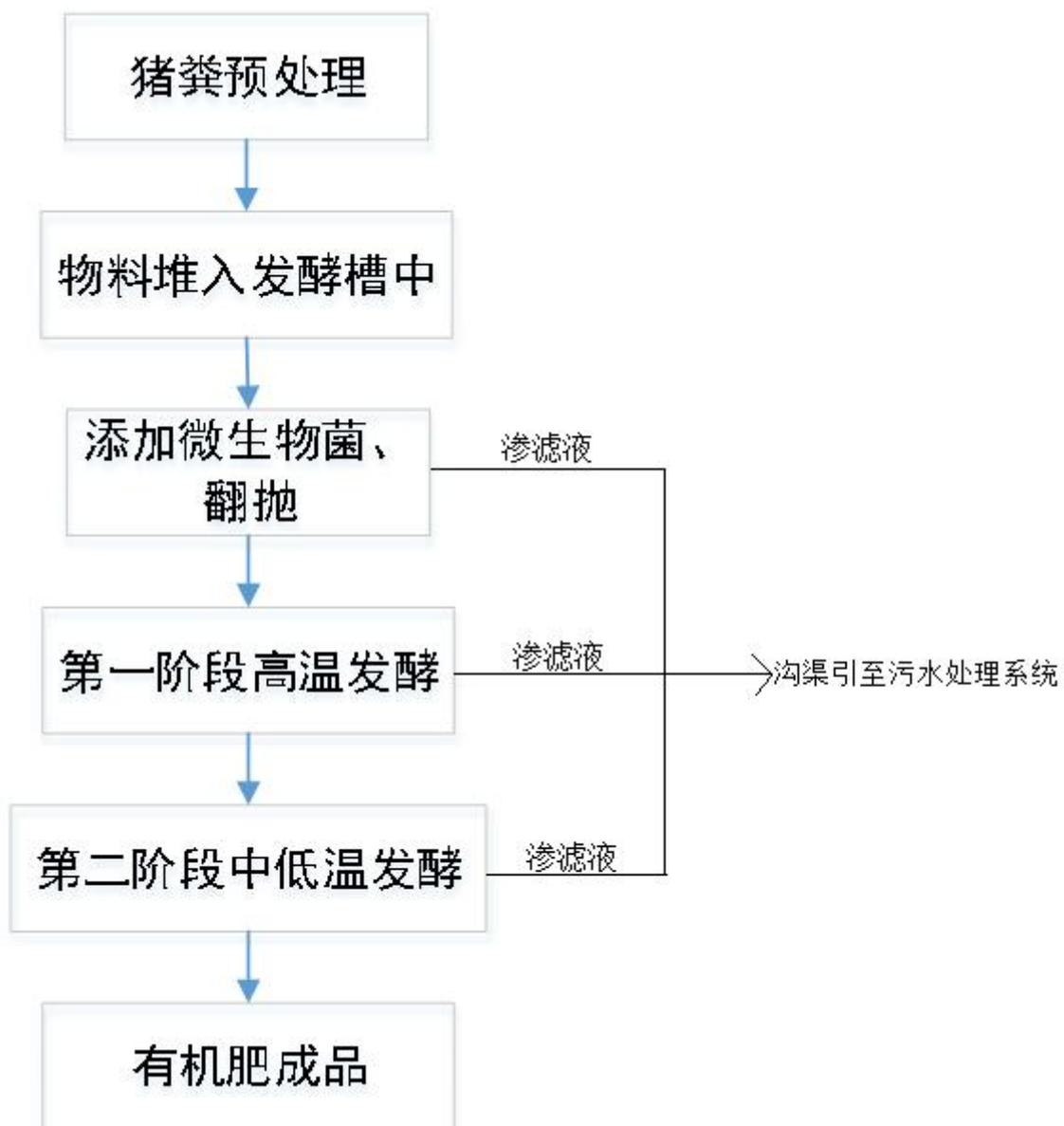
图3.2-9 项目堆肥发酵工艺流程图
