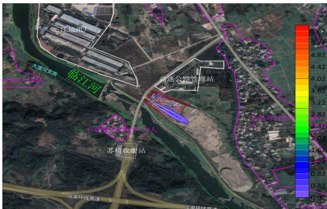
图 8.4-1 本项目调节池渗漏 COD Mn 污染物持续注入含水层后 10d 迁移范围图
