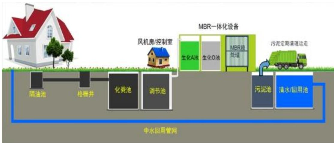
图 6.4.3-1 MBR 污水处理工艺流程
